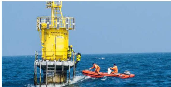
Energien (Solar und Wind) versorgt. Bei diesen Nordsee-Messbojen ist Strom bzw. die Energieversorgung ein entscheidendes Kriterium.
